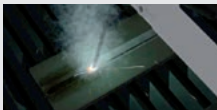
Simulační sekvence ručního obloukového svařování
