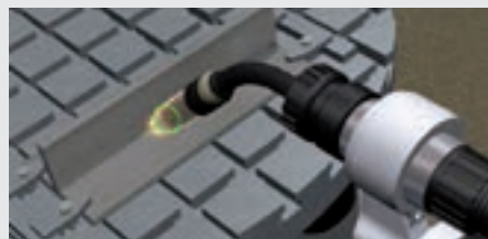
Tréninková sekvence mechanizovaného svařování MAG
